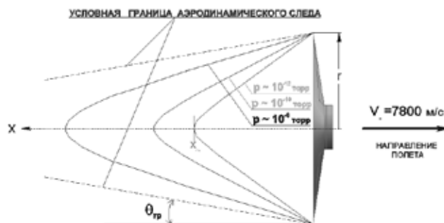
Рис. 1. Уровни разрежения за ЗЭ при поперечном обтекании в условиях орбитального полета
