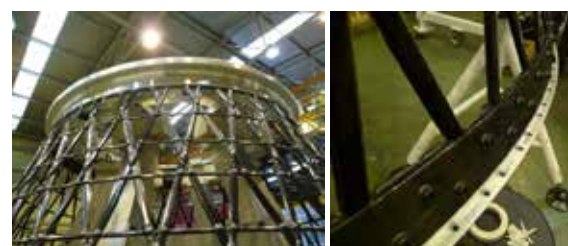
Рис. 13. Сетчатая конструкция конического адаптера для РН Vega
