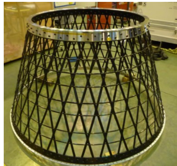
Рис. 11. Прототип сетчатого конического адаптера для РН Vega
