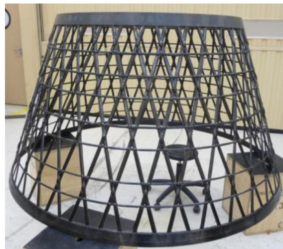
Рис. 12. Сетчатая конструкция конического адаптера для РН Vega
