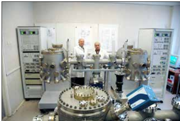
Рис. 4. Двухкамерная установка «Катунь-100» на сборочном участке в ИФП СО РАН
