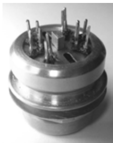
Рис. 4. Измерительная головка микрокалориметра для крепления двух параллельных пленок с датчиками температуры и нагревателями
