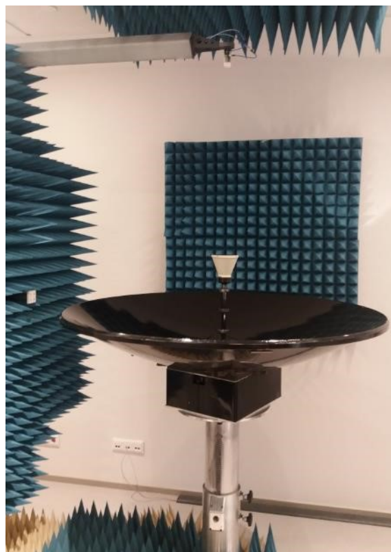
Рис. 7. Рабочее место стенда с установленной зеркальной антенной с диаметром рефлектора 1,2 м
