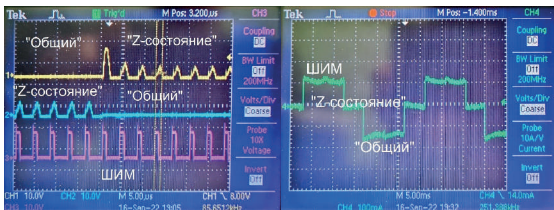
Рис. 9. Осциллограмма напряжений на 3-х обмотках в момент перехода с одной фазы поворота на другую (слева) и осциллограмма тока на одной из обмоток за два оборота двигателя (справа) – каждый оборот состоит из 6 фаз
