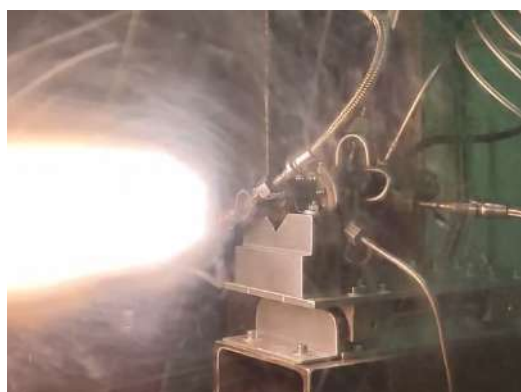
Рис. 3. Испытания опытного образца ракетного двигателя на газообразных кислороде и водороде в лаборатории БГТУ «ВОЕНМЕХ» им. Д. Ф. Устинова
