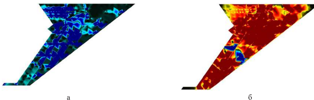
Рисунок 7. Распределения изменений узловых жесткостей в результате коррекции: а – по одному тону; б – по пяти тонам
