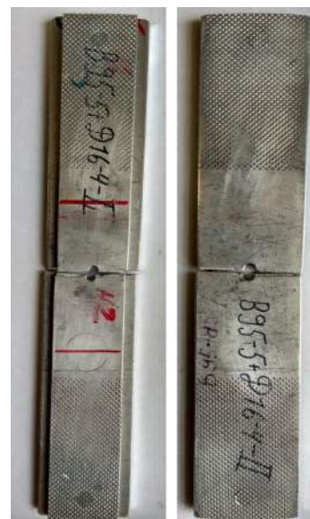
Рисунок 3. Испытанный комбинированный образец после разрушения с фронтальной и тыловой сторон
