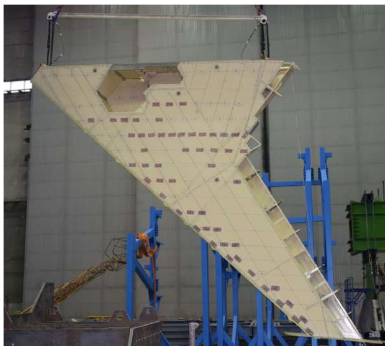
Рисунок 6. Модальные испытания консоли крыла
