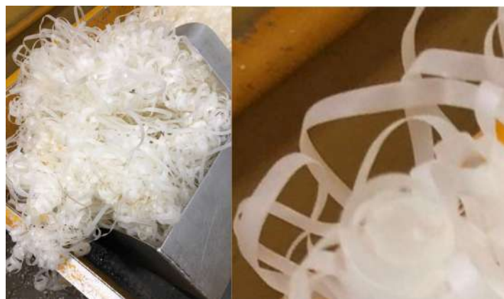
Рисунок 2. Пример образования стружки при механической обработке полиамида
