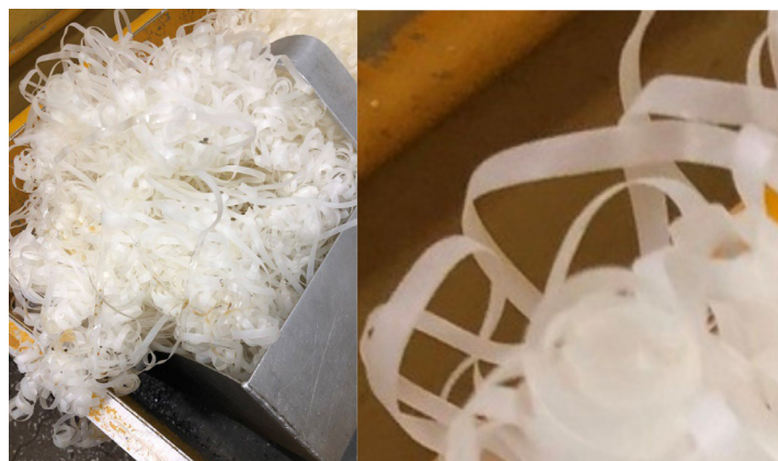
Рисунок 2. Пример образования стружки при механической обработке полиамида
