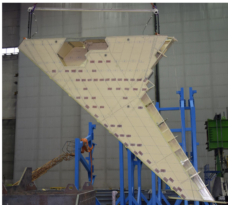
Рисунок 6. Модальные испытания консоли крыла
