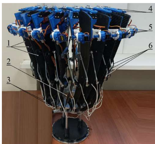
Рисунок 11. Физическая модель лепесткового зеркала в сложенном состоянии. Обозначения: 1 – лепестки, 2 – центральное зеркало, 3 – сферические шарниры, соединяющие лепестки с основанием зеркала, 4 – узлы системы предварительного раскрытия, 5 – замки высокоточной фиксации, 6 – тяги, соединяющие соседние лепестки
