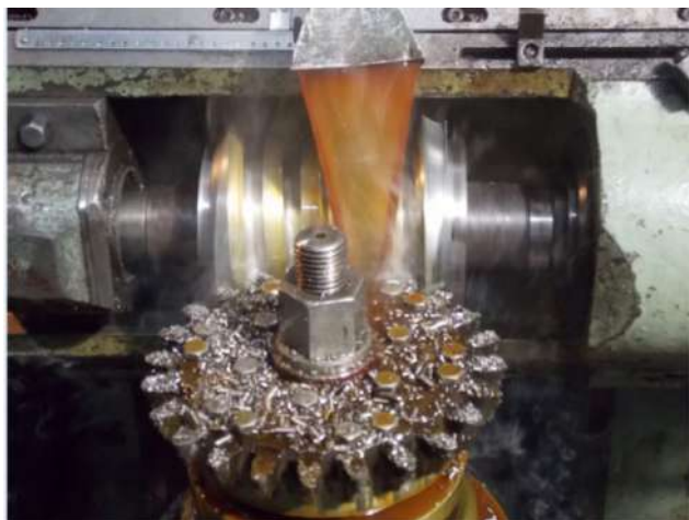
Рисунок 4. Нарезание витков глобоидного червяка с вогнутым эвольвентным профилем
