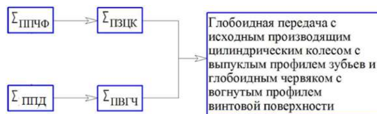
Рисунок 3. Схема образования зацепления поверхностей глобоидной пары с вогнутым эвольвентным профилем глобоидного червяка и выпуклым эвольвентным профилем зубьев сопряженного с глобоидным червяком цилиндрического колеса: \Sigma_{ППЧФ} – производящая поверхность цилиндрической червячной фрезы для нарезания зубьев сопряженного колеса глобоидной передачи и зубьев многолезвийного инструмента с эвольвентным профилем для нарезания винтовой поверхности глобоидного червяка с вогнутым профилем; \Sigma_{ППД} – производящая поверхность долбяка; \Sigma_{ПЗЦК} – поверхность зубьев сопряженного цилиндрического колеса с выпуклым эвольвентным профилем; \Sigma_{ПВГЧ} – поверхность витков глобоидного червяка с вогнутым профилем, нарезанных многолезвийным инструментом ротационным точением
