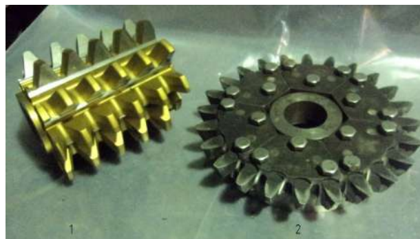
Рисунок 5. Червячная цилиндрическая фреза (1) и резцовая головка с эвольвентным профилем режущих элементов (2)
