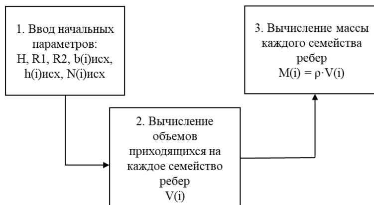
Рисунок 2. Блок-схема расчета массы
